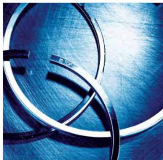
Trzy pierścienie tłokowe. Należy zawsze zwracać uwagę na znakowanie TOP. Przy pierścieniach znakowanych TOP należy je montować znakowaniem do góry w kierunku denka tłoka.
